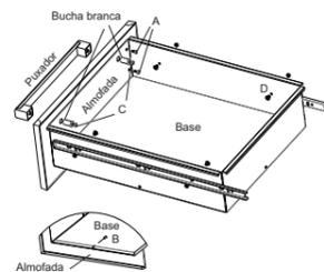
3) Fixe os parafusos A (3,9x9,5) na almofada, travando a gaveta. Utilize o parafuso B (3,9x9,5) para fixar a base na almofada. Encaixe a bucha branca e os parafusos C (3,9x9,5) juntos, no furo da almofada. Posicione o puxador e aperte os parafusos. Posicione o trilho menor, alinhando-o sobre os furos da lateral do gavetão. Utilize os parafusos D (M4x6) e as porcas M4 para fixar.
