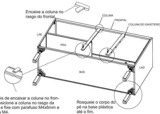
Depois de encaixar a coluna no frontal posicione a coluna no rasgo da base e fixe com parafuso M4x6mm e porca M4.
